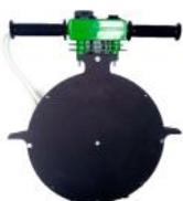
**Нагревательный элемент.** Оснащен терморегулятором, обеспечивающим поддержание заданной температуры; антипригарным покрытием рабочих поверхностей, соединительным кабелем и сетевым штекером, выключателем «включено/выключено», температура регулируется от 180-230°C, Вес нагревателя 6.3 кг.
