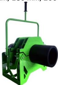
**Центратор двухзажимный.** Состоит из усиленной станины, на котором крепятся два хомута, со стандартных наборов вкладышей 90, 110, 160 мм. Один хомут зафиксирован на станине второй подвижный приводится в движение системой рычагов. Контроль усилия сжатия определяется динамометрическим ключом. Габаритные размеры 491\*850\*357 мм. Вес центратора 42 кг.
